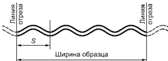
Рисунок 19 - Схема обрезки целых листов перед испытанием
